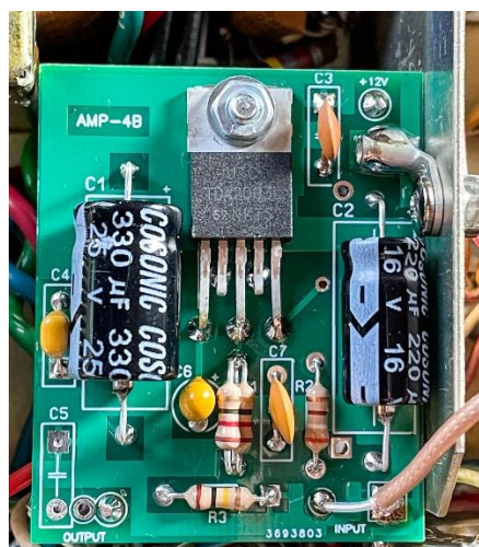
Bild 9b: NF-Verstärker fertig montiert
