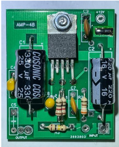
Bild 8: NF-Verstärker bereit für den Einbau
