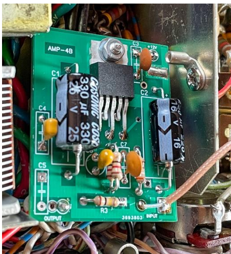
Bild 9a: NF Verstärker verdrahtet
