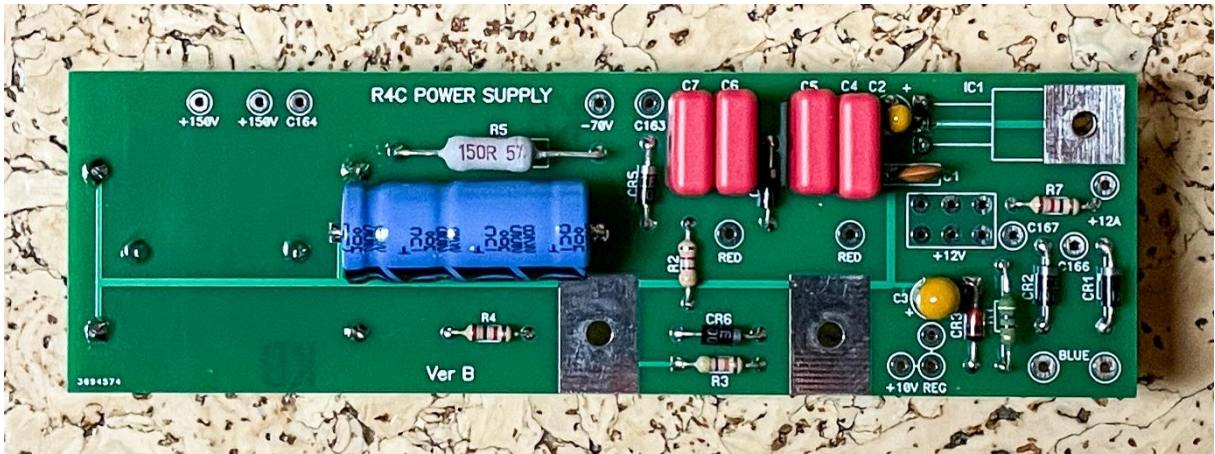
Bild 4a: Netzteilplatine nach Bestückung, Oberseite
