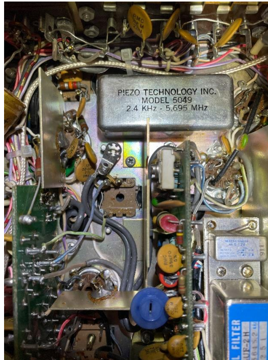
Bild 11b: Schirmblech entfernt
